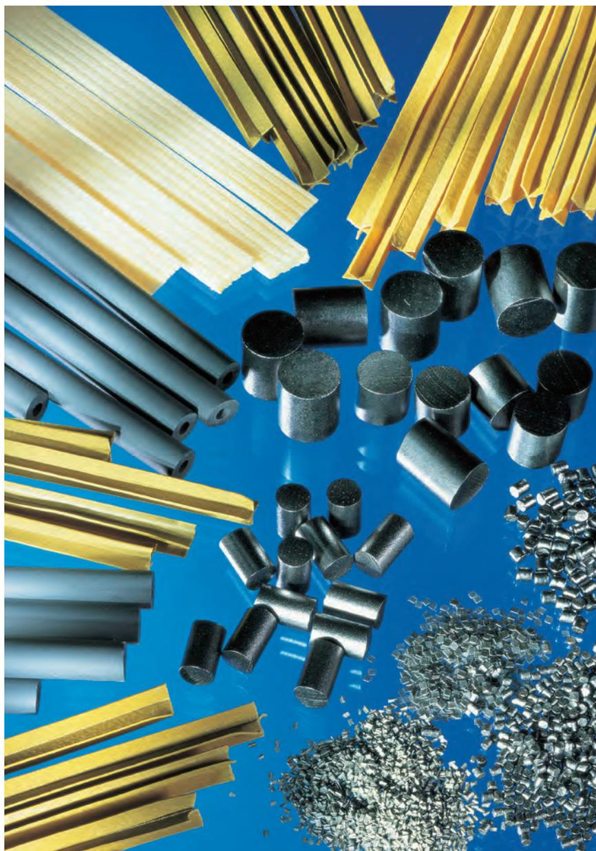
Die Vielfalt der Treibladungspulver, die in Wimmis hergestellt werden, ist gross. Sie reicht von ganz kleinen Teilchen für Airbags bis hin zu grossen Treibladungspulver-Elementen für Panzermunition.
