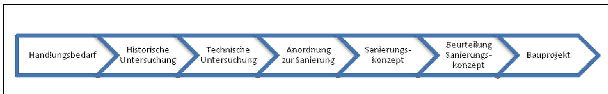
Abbildung 3: Prozesskette von der Feststellung des Handlungsbedarfs bis zum Erstellen der Bauprojektunterlagen (Altlastenprozess)
